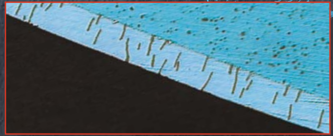
Im Querschliff ist die Mikrorissigkeit von Hartchromschichten deutlich sichtbar (Schichtdicke 15 µm)
